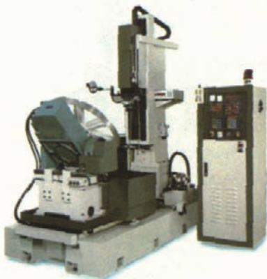
图6 轮胎模具的电火花加工专用机床
