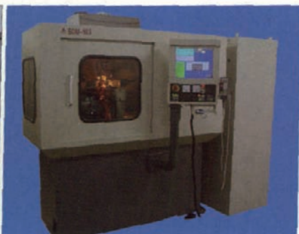
图5 BDM-903精密数控电火花工具磨床
